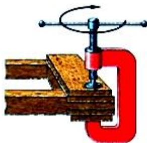
Рис. 29. Зажим шипового соединения при склеивании
