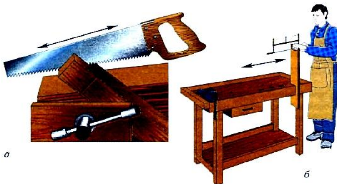
Рис. 24. Приемы продольного пиления шиповых соединений: а — запиливание; б — окончательное выпиливание
